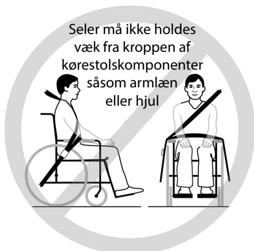
Figur 3a – Forkert positionering af bækkenseler over kørestolsstøtter.
