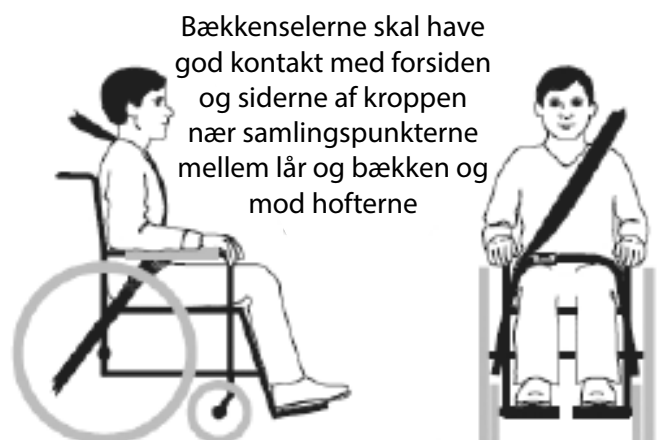
Figur 3b – Korrekt føring og positionering af seler på kørestolspassageren.
