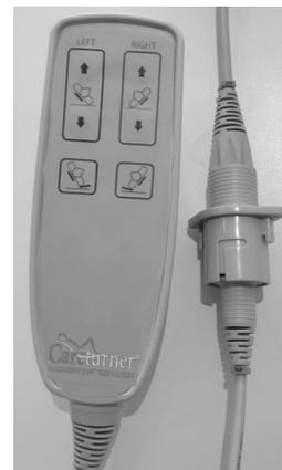
Schließen Sie die Handbedienung an Kabel ② und das Netzkabel ① an das Stromnetz an. Das Handbedienungskabel ist an der Kabelschelle mit ③ gekennzeichnet, was der Markierung ③ am Kontrollbox-Kabel entspricht.
