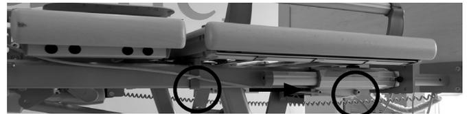
Führen Sie auf beiden Seiten des Bettes das Motorkabel an der Seite des Bettrahmens zum Fußende (angezeigt durch den Pfeil im Bild) und befestigen Sie jedes der Kabel mit Kabelbindern am Rahmenrohr. Stellen Sie sicher, dass beide Motorkabel mit Kabelbindern befestigt sind (gekennzeichnet durch die Kreise im Bild), der erste Kabelbinder am Kunststoffschutz und der zweite unter dem Bettrahmen. Stellen Sie sicher, dass die Enden der Kabelbinder nicht vom Bettrahmen her nach außen zeigen.
